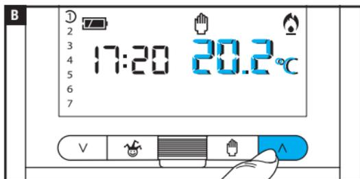
Sul display, oltre all'ora corrente, viene mostrato il set-point di temperatura manuale preimpostato (20°C).
